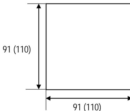
Примечание – Без скобок указаны размеры окна для крепления ИП конструктивного исполнения Е, в скобках – для крепления ИП конструктивного исполнения Р
