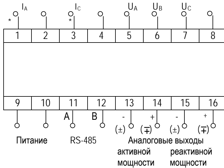
Рисунок А.2 – Схема электрическая подключения ИП, имеющих аналоговые выходы
